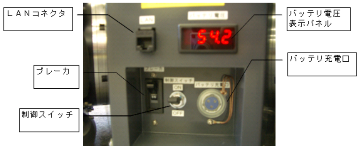
図 5 移動ユニットの操作パネル
