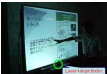
LRFを用いた手の動きによるスライド操作
