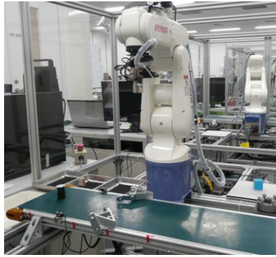
図1 RTM-ORiNコンバータを用いて作成したピック&プレイス作業を行うロボットシステム
