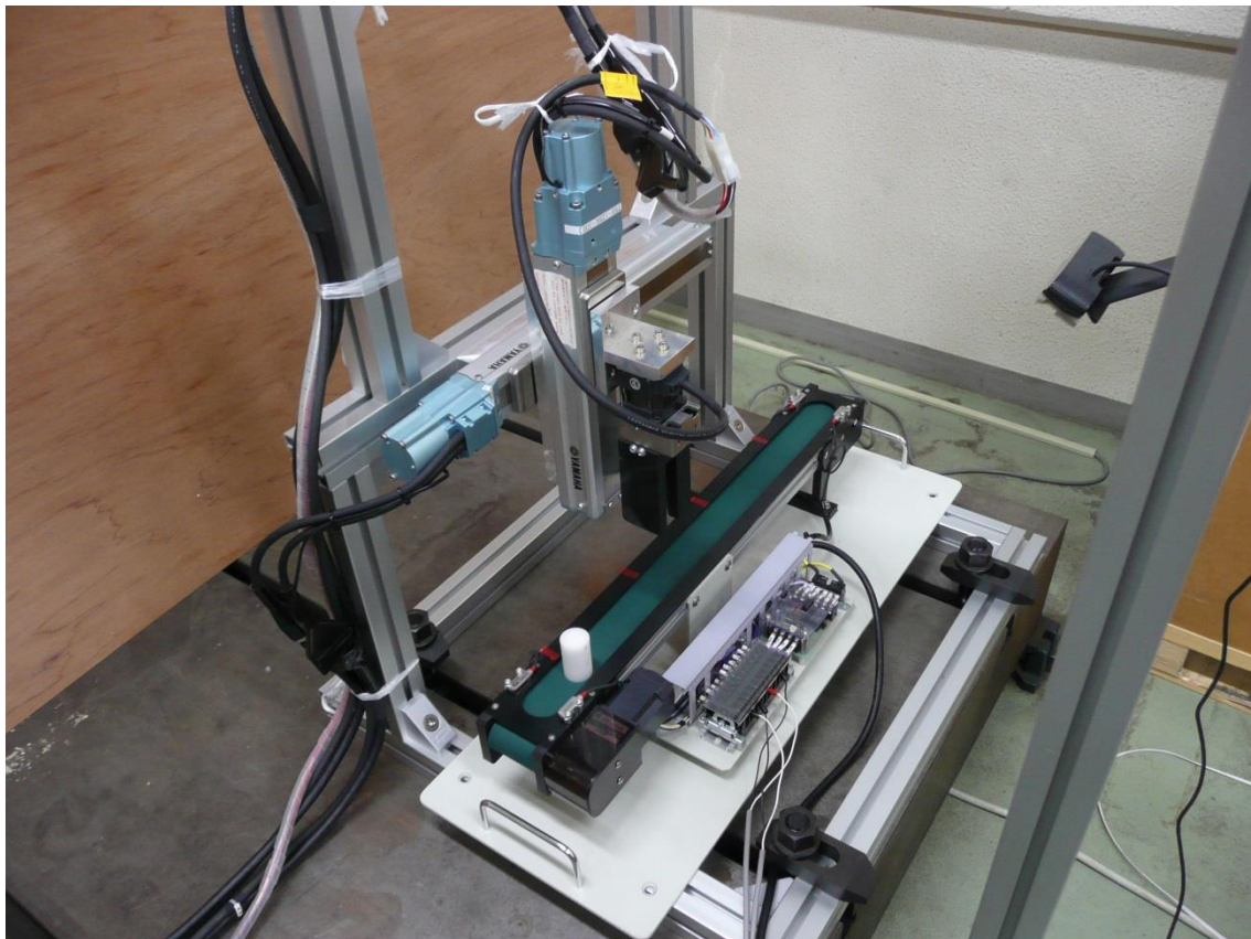
図 2.1.1 画像処理を用いてピック&プレースを行うためのハードウェア環境 (定盤上に構築)
