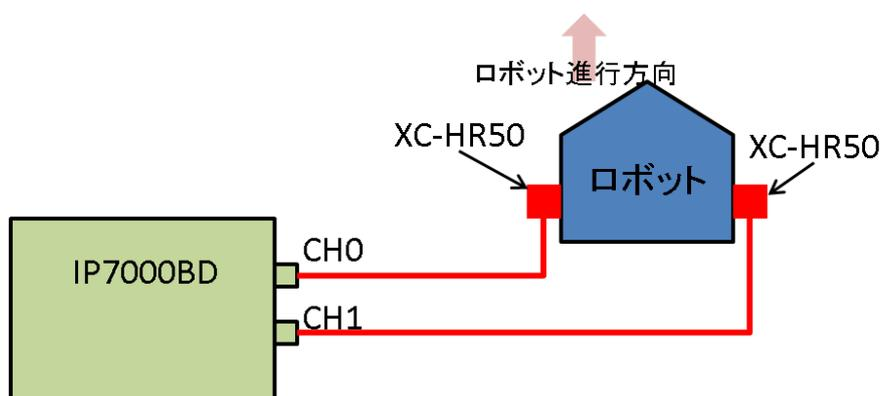
図 4-7 画像処理ボードとカメラの接続
