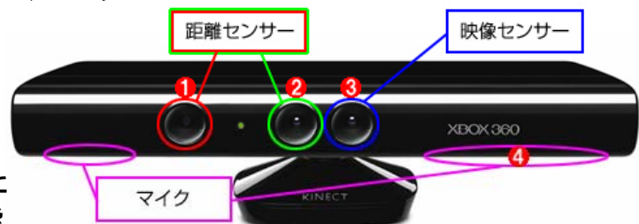
図 Kinectセンサーの外観と各センサー機能
