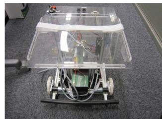
リファレンスロボットはWiiRemoteVelocityRTCやGamePadRTCを組み合わせることで手動制御による移動が可能となります
