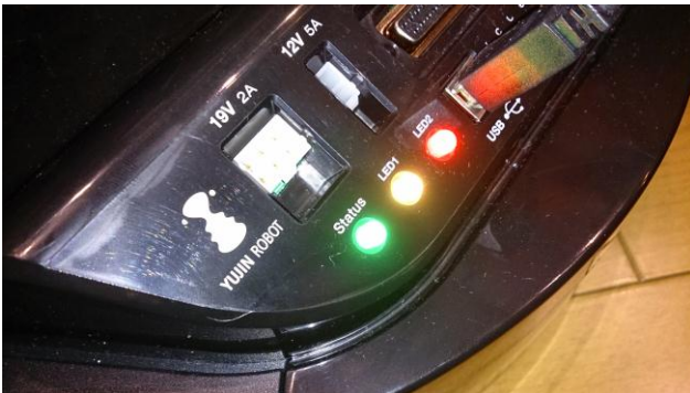
図8 BeagleBoneBlackで動いているRTコンポーネントから、Kobuki上のLEDの制御を行った
