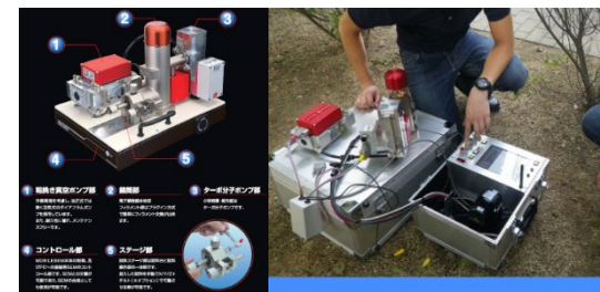
新日本電工他: Mobile SEM
